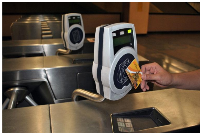
Figure 7 : portillon RFID dans une station de métro (crédit : Protoplasmakid/WikimediaCommons)
