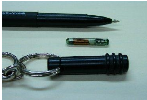
Figuur 12: RFID-tag geïntegreerd in de Speedpass-sleutelhanger (bron: Atkinson/WikimediaCommons)
