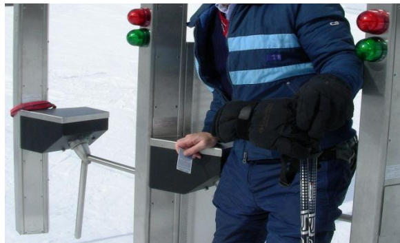
Figuur 6: Mechanische skiliften gebaseerd op RFID (bron: Baileypalblue/WikimediaCommons)
