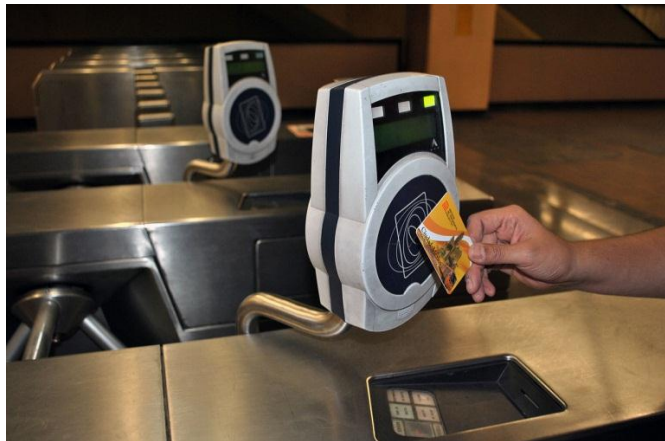
Figuur 7: RFID-klapdeur in een metrostation (bron: ProtoplasmaKid/WikimediaCommons)
